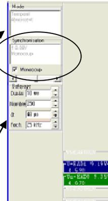
**Balayage** : permet de choisir la **durée totale de l'acquisition** et le **nombre de points total** : le logiciel calcule alors la fréquence d'échantillonnage fech et l'intervalle de temps  $\delta t$  entre 2 points de mesure.
