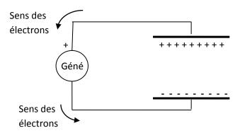
Au niveau microscopique, des électrons circulent en rentrant par la borne + du générateur donc quittent, sur le dessin précédent, l'armature supérieure qui se charge alors positivement par défaut d'électrons. L'armature inférieure se charge, elle, négativement, par excès d'électrons qui viennent s'y accumuler.
