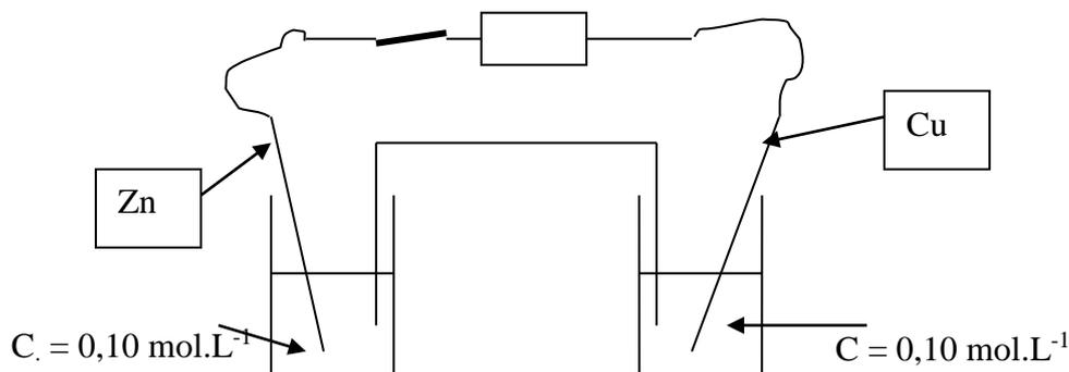
Un courant apparaît dans le circuit : un transfert d'électrons a lieu via le circuit. Dans les conditions de cette pile, on observe un transfert réel d'électrons de l'élément zinc vers l'élément cuivre :
